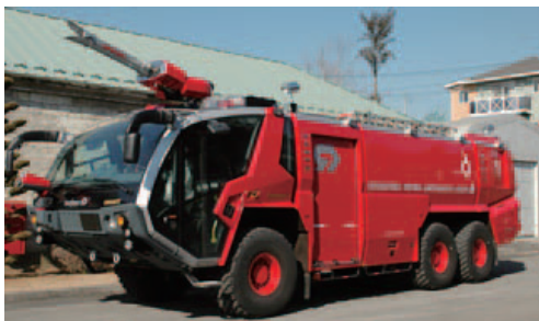
大型放水砲搭載ホース延長車
