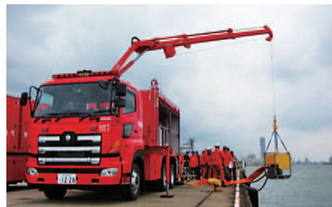
大容量送水ポンプ車
